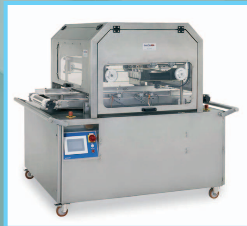
Machine à trancher pour produits rectangulaires (avec ou sans cadre)
