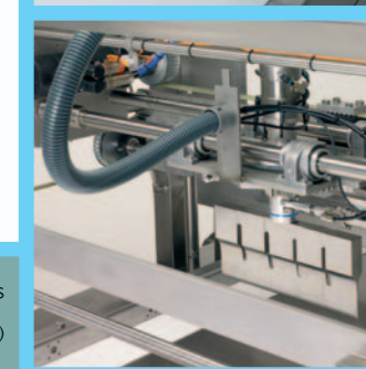
Machine à trancher pour produits rectangulaires (avec ou sans cadre)
